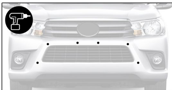
F) Depois de posicionar o overbumper, fazer a furação conforme locais marcados com tinta na etapa anterior.
