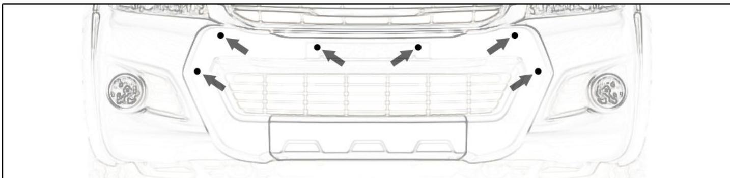
H) Utilizar 6 arruelas 1/4 e 6 porcas M6 fixando-as nos prisioneiros do overbumper pela parte interna do para-choque.
