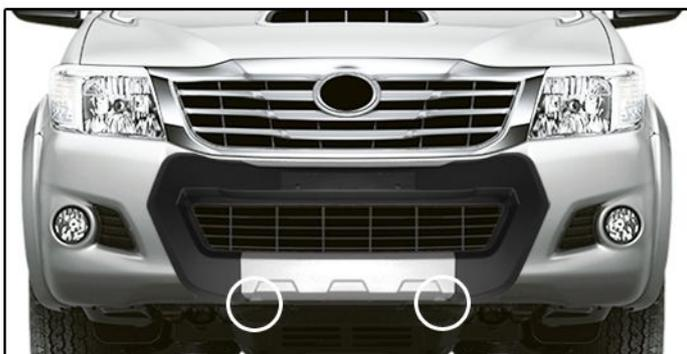
I) Finalizar a fixação recolocando os grampos retirados na etapa "F".
