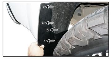
F) Posicionar corretamente a peça e fazer a furação no veículo conforme locais indicados no Apara Barro.
