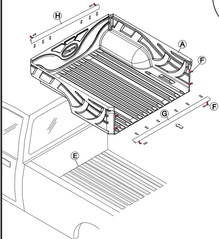
3. Posicione o protetor de caçamba no veículo, conforme indica as figuras, para encaixar as laterais do protetor é necessário puxar a parte central do protetor e pressionar as laterais encaixando em baixo das bordas laterais da caçamba.
