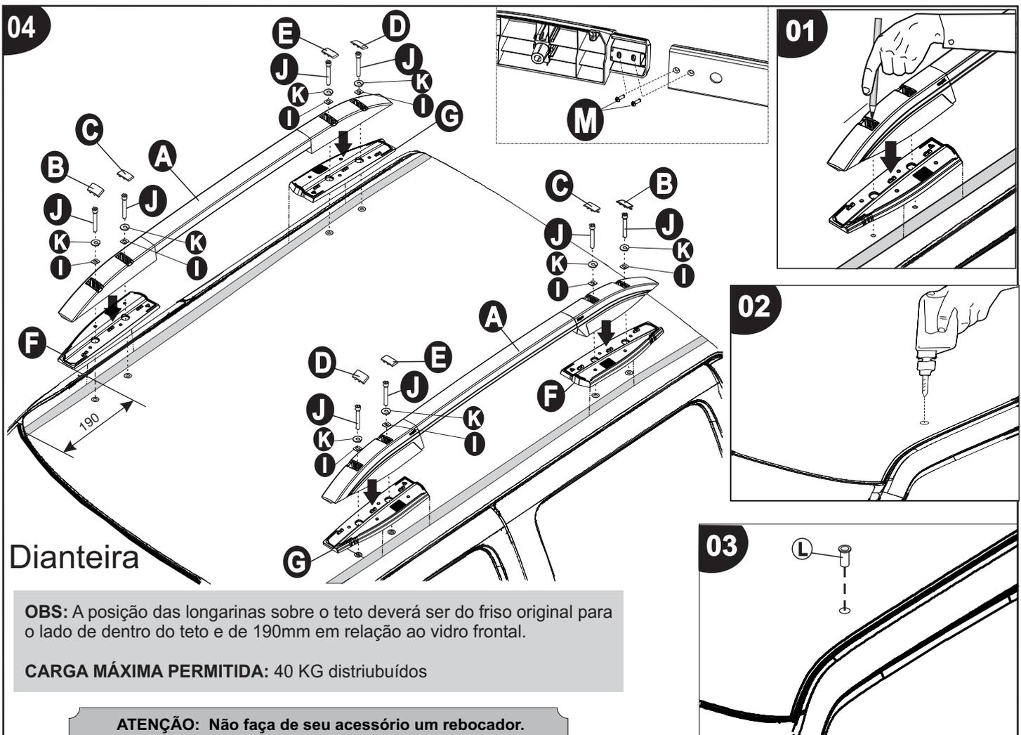
**OBS:** A posição das longarinas sobre o teto deverá ser do friso original para o lado de dentro do teto e de 190mm em relação ao vidro frontal.
