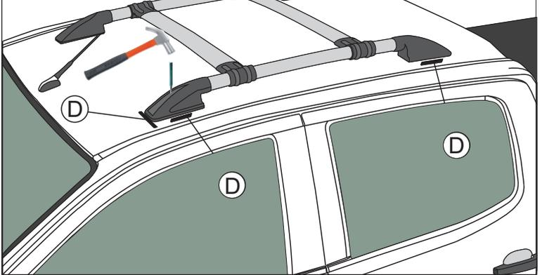
Obs: Para efetuar a montagem do bagageiro retire o item "E" e "C", insira o item "B", inserindo novamente os itens "E" e "C", mas deixando todos os parafusos frouxos.
