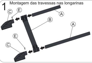
Obs: Para efetuar a montagem do bagageiro retire o item "E" e "C", insira o item "B", inserindo novamente os items "E" e "C", mas deixando todos os parafusos frouxos. OBS: Monte-o em uma superfície plana fora do veículo.
