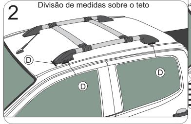
**Obs**: Após a montagem conforme figura 1 posicione o bagageiro sobre o teto utilizando item´´D`` e auxilio de uma trena divida igualmente o espaço entre as bordas laterais do teto do veículo, cole o item´´D`` e posicione a seu gosto a posição da peça para frente ou para traz, de modo em que as sapatas fiquem bem assentadas de acordo com a curvatura do teto do veículo.
